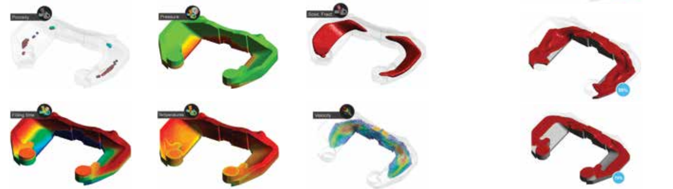
주조 시뮬레이션을 통한 자세한 컨투어 및 벡터의 예시
